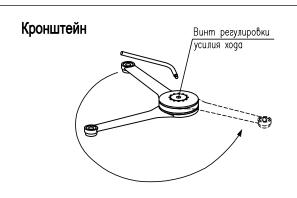
Механизм кронштейна должен <u>тяжело</u> разжиматься и <u>легко</u> сжиматься. При необходимости перевести рычаг в нужный режим.
